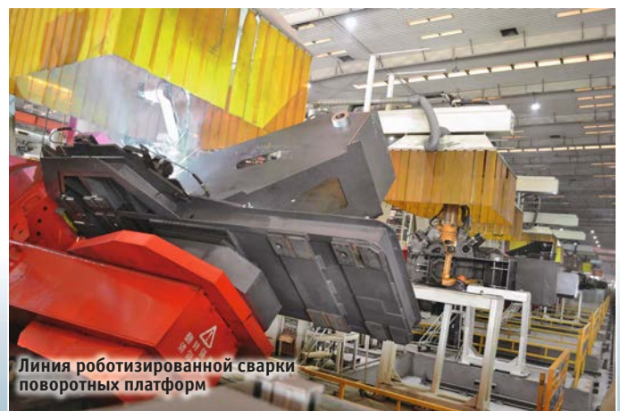
Опоры стрелы на линии сварки поворотных платформ
