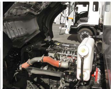
Кабина «Компаса» наклоняется и открывает удобный доступ к двигателю
