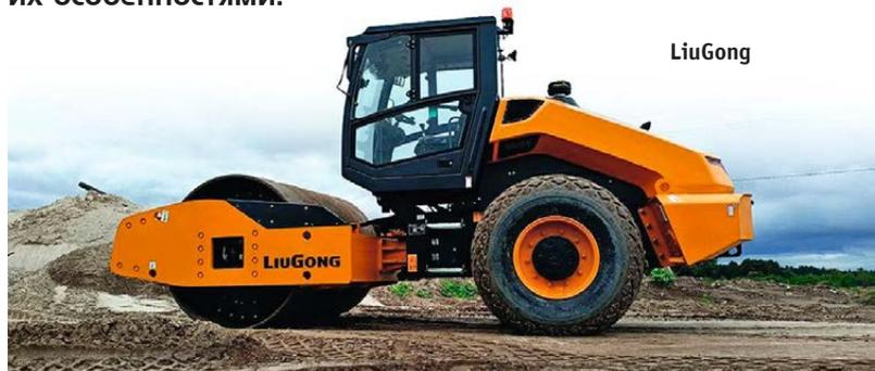
ской нагрузки по ширине вальца обеспечивает высочайшую однородность уплотнения.
