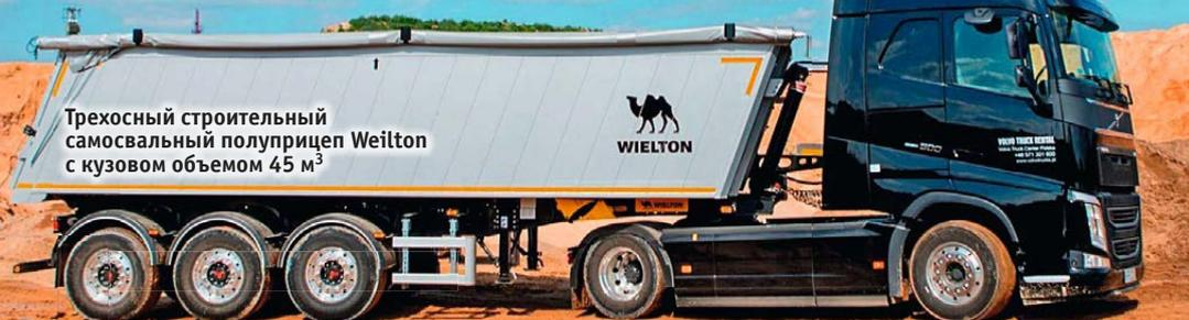
Трехосный строительный самосвальный полуприцеп Weilton с кузовом объемом 45 м<sup>3</sup>
