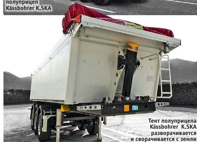
Тент полуприцепа Kässbohrer K.SKA разворачивается и сворачивается с земли
