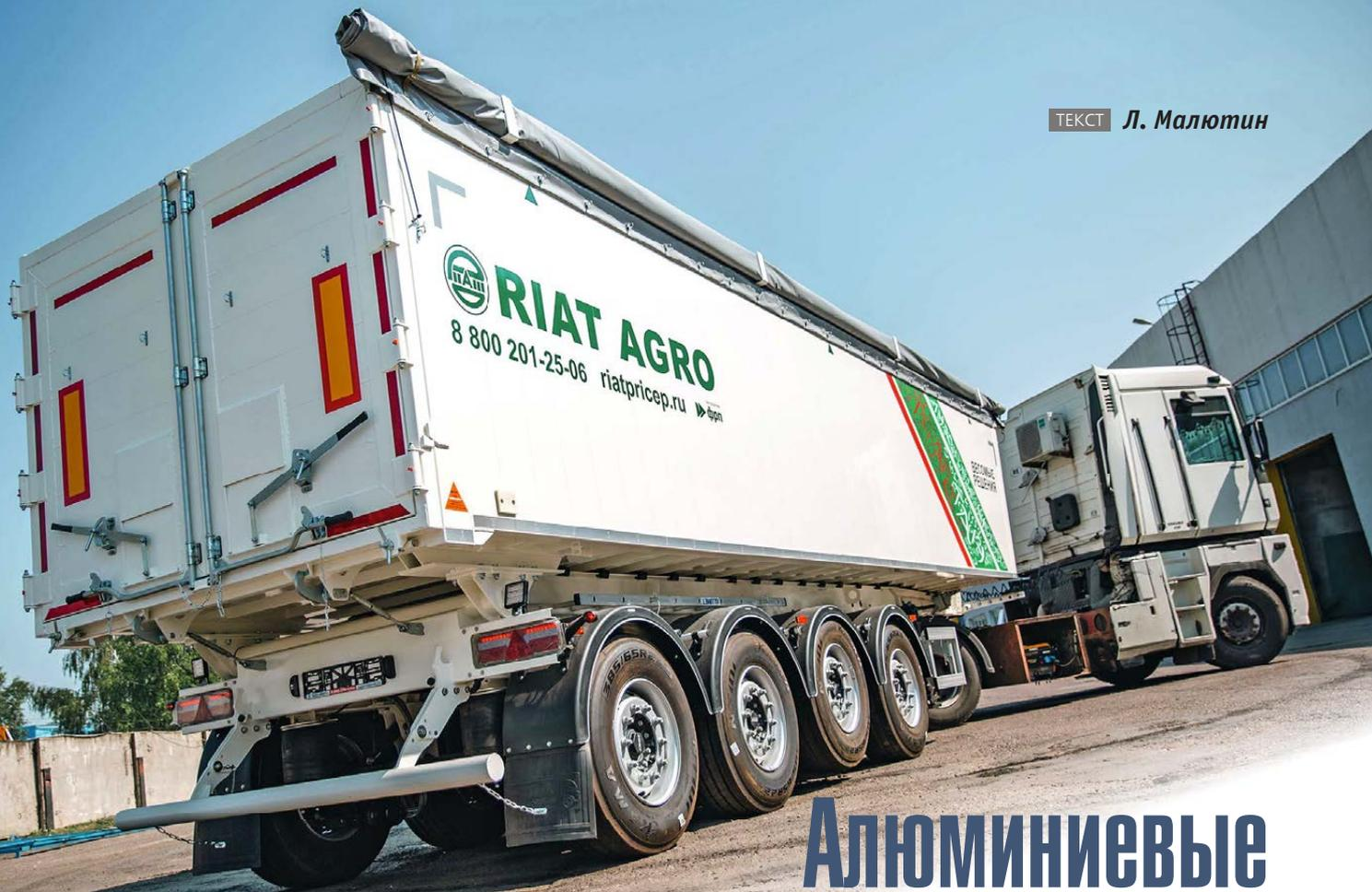
Алюминиевые сплавы интересны производителям самосвальной техники благодаря тому, что алюминиевый кузов получается примерно на полторы тонны легче аналогичного стального и практически у каждого производителя самосвальной техники производственная программа включает полуприцепы с алюминиевыми кузовами.
