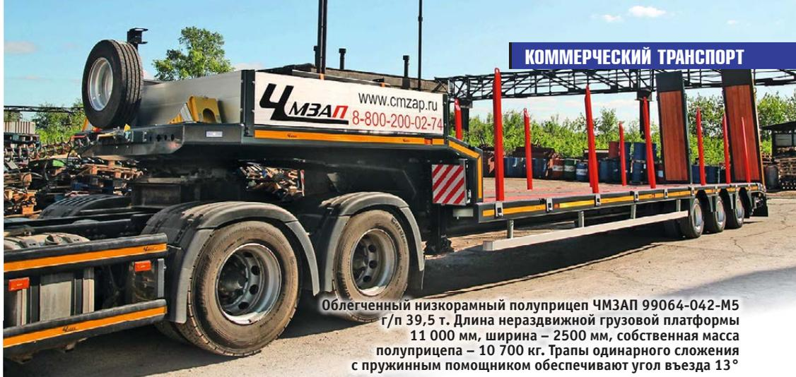
Облегченный низкорамный полуприцеп ЧМЗАП 99064-042-М5 г/п 39,5 т. Длина нераздвижной грузовой платформы 11 000 мм, ширина – 2500 мм, собственная масса полуприцепа – 10 700 кг. Трапы одинарного сложения с пружинным помощником обеспечивают угол въезда 13°
