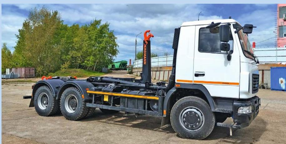
Угол опрокидывания контейнера в самосвальном режиме – до 52°. Механизм фиксации контейнеров наружного исполнения с гидравлическим приводом. Для плавного опускания контейнера на опоры погрузчик оснащен функцией «Плавный стоп».
