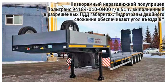
Низкорамный нераздвижной полуприцеп Политранс 94184-010-0И00 г/п 51 т, выполненный в разрешенных ПДД габаритах. Гидротрапы двойного сложения обеспечивают угол въезда 8°
