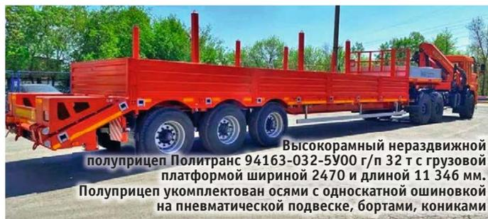
Высокорамный нераздвижной полуприцеп Политранс 94163-032-5У00 г/п 32 т с грузовой платформой шириной 2470 и длиной 11 346 мм. Полуприцеп укомплектован осями с односкатной ошиновкой на пневматической подвеске, бортами, кониками
