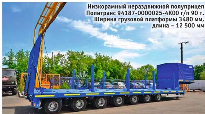
Низкорамный нераздвижной полуприцеп Политранс 94187-000025-4К00 г/п 90 т. Ширина грузовой платформы 3480 мм, длина – 12 500 мм
