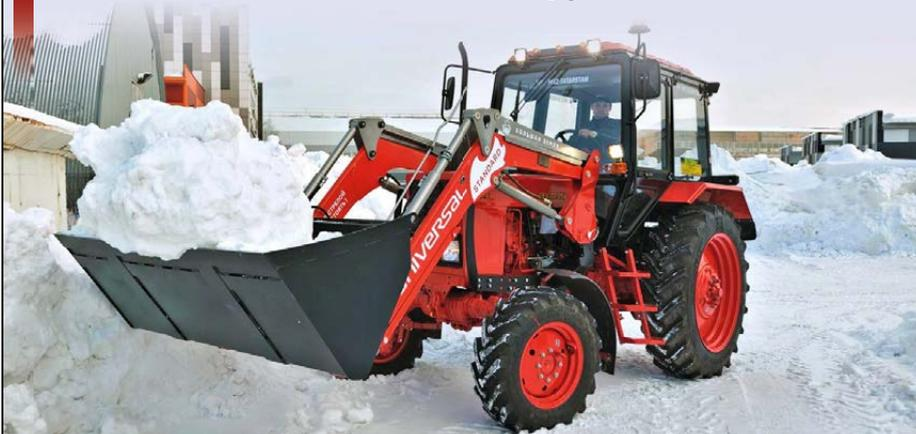
ООО «Большая Земля» (г. Пермь) с 2025 году производит свои навесные погрузчики Универсал Standard нового поколения грузоподъемностью 1350 кг и с высотой подъема 3850 мм. Вместимость ковша 0,4–1,2 м<sup>3</sup>. Рычажная система обеспечивает параллельное положение ковша на всей высоте подъема.
