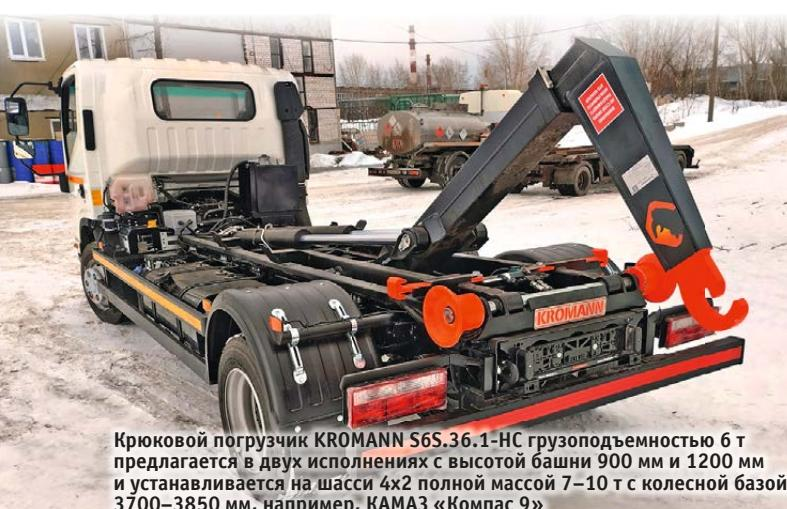
Крюковой погрузчик KROMANN S6S.36.1-НС грузоподъемностью 6 т предлагается в двух исполнениях с высотой башни 900 мм и 1200 мм и устанавливается на шасси 4x2 полной массой 7–10 т с колесной базой 3700–3850 мм, например, КАМАЗ «Компас 9»
