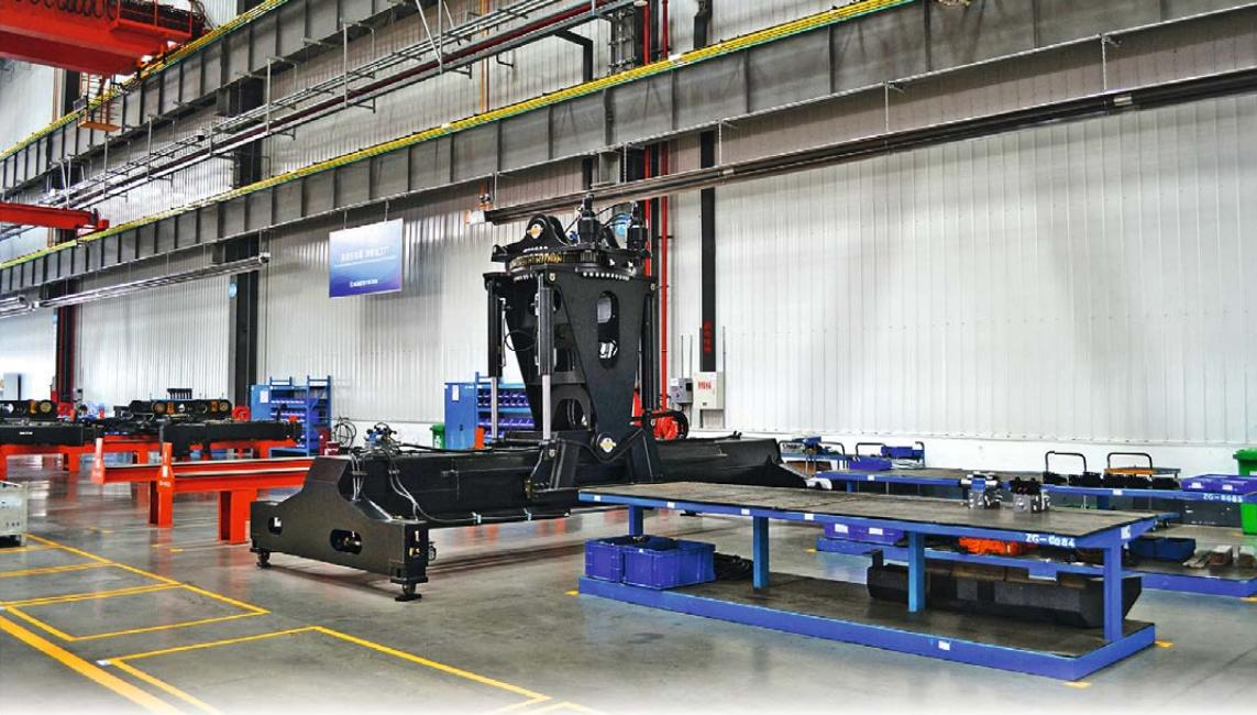
После сварки металлоконструкции помещают в крупногабаритные металлообрабатывающие центры для соосной расочки отверстий и обработки посадочных поверхностей. Затем конструкции отправляются на пескоструйную очистку и окраску. Машины предназначены для эксплуатации в агрессивной среде морского порта, и к лакокрасочному покрытию
