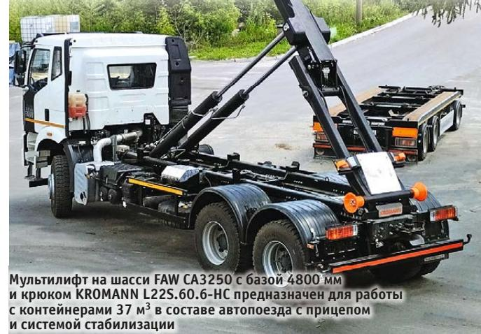
Мультилифт на шасси FAW CA3250 с базой 4800 мм и крюком KROMANN L22S.60.6-НС предназначен для работы с контейнерами 37 м<sup>3</sup> в составе автопоезда с прицепом и системой стабилизации
