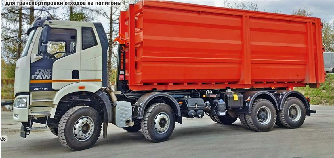
Постепенно осваивают рынок и занимают свою нишу мультилифты на шасси Sitrak и Howo. В этих машинах есть приятная техническая особенность: 8- и 9-тонные передние оси на шасси 6x4. С точки зрения осевых нагрузок у трехосных длинно-базных мультилифтов часто при номинальной грузоподъемности оказывается перегруженной передняя ось на 700–1500 кг, и для устранения перегруза приходится ограничивать грузоподъемность. Более мощные перед-
