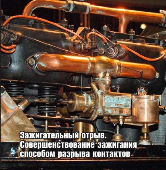
**Зажигательный отрыв. Совершенствование зажигания способом разрыва контактов**
