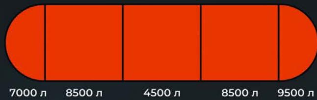
Перевозка только дизеля с 1-им пустым отсеком
