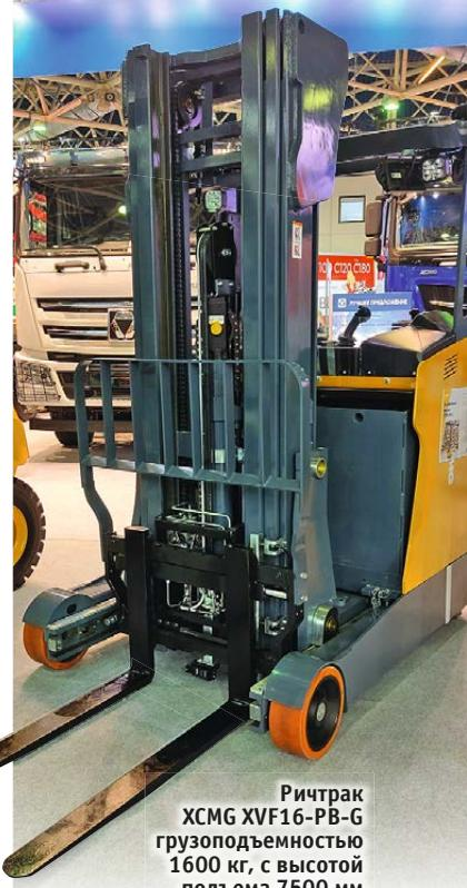
Ричтрак XCMG XVF16-PB-G грузоподъемностью 1600 кг, с высотой подъема 7500 мм
