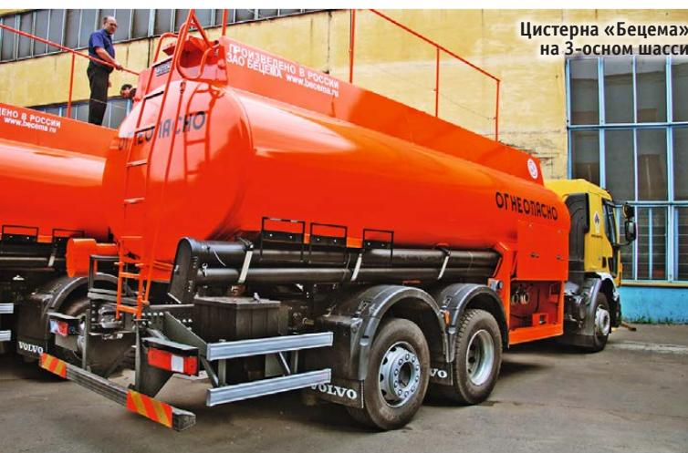
Не забыты и водители: для их удобства модели имеют кроме просторных технологических ящиков дополнительные ящики ЗИП, устанавливаются дополнительные габаритные огни, трап для увеличения рабочей верхней зоны, разные варианты коллекторного слива для упрощения процесса разгрузки, фонари подсветки, для того чтобы не портить зрение при работе в темное время суток, рукомойник с жидким мылом для приведения себя в порядок и многое другое.
