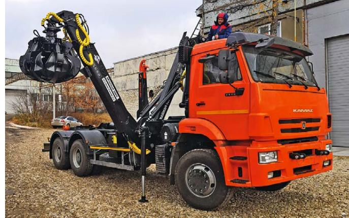
Они просты в управлении и обслуживании, надежны и неприхотливы в эксплуатации. Металлическая силовая конструкция грамотно просчитана специальными программами, имеет усиители в местах концентрации нагрузки и большой запас прочности. Лонжероны Z-образного профиля главной рамы тяжелых крюков серии L и XL согнуты из листовой конструкционной стали S500MC или S600 MC толщиной 8 мм.
