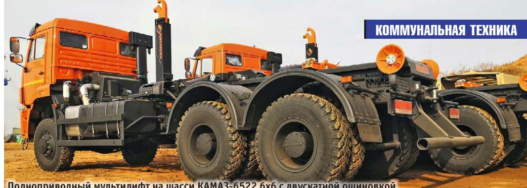
Полноприводный мультилифт на шасси КАМАЗ-6522 6х6 с двускатной ошиновкой с крюком KROMANN L22S.57.6-НС – стандартное готовое решение для полигонов ТБО
