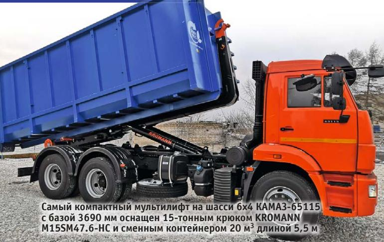
Самый компактный мультилифт на шасси 6x4 КАМАЗ-65115 с базой 3690 мм оснащен 15-тонным крюком KROMANN M15SM47.6-НС и сменным контейнером 20 м<sup>3</sup> длиной 5,5 м
