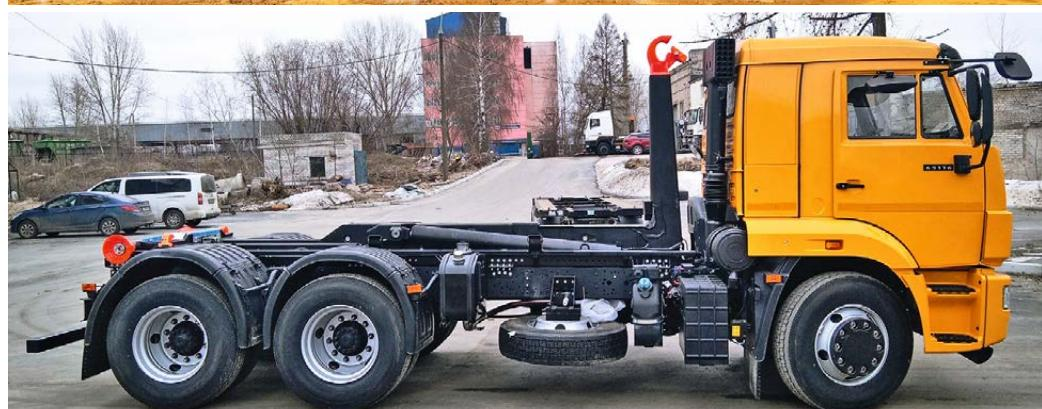
Короткобазный мультилифт полной массой 25 т на шасси КАМАЗ-65115 со спальной кабиной и крюком KROMANN M15S.47.6-НС соответствует требованиям по разрешенной полной массе для 3-осных автомобилей интегрированную в гидрозамок главных цилиндров, что позволяет аккуратно и плавно опустить смешной контейнер и установить его на опоры главной рамы.
