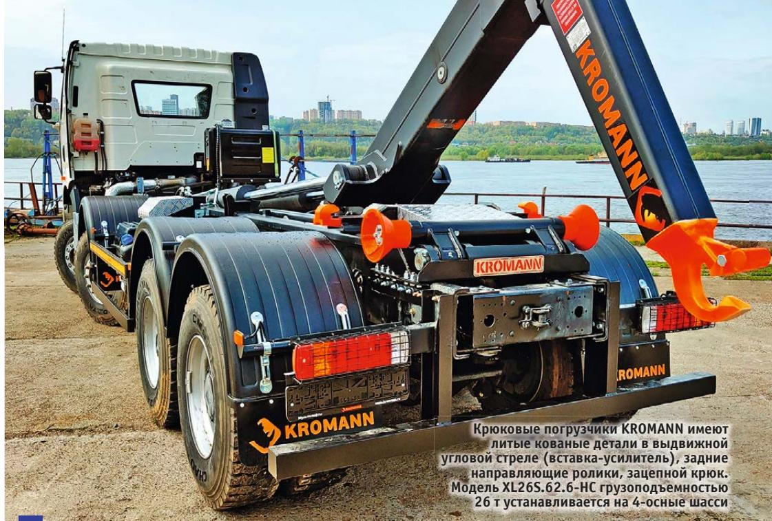
Крюковые погрузчики KROMANN имеют литье кованые детали в выдвижной угловой стреле (вставка-усилитель), задние направляющие ролики, зацепной крюк. Модель XL265.62.6-НС грузоподъемностью 26 т устанавливается на 4-осные шасси
