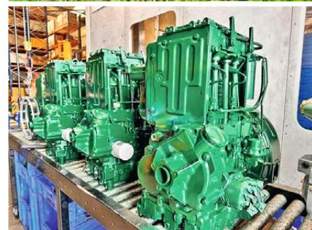
На заводах в Китае, где собираются двигатели Lister Petter, современное производство. Некоторые производственные процессы более традиционны для продуктов экологического класса Stage 2, но если посмотреть на двигатели класса Stage 5, производственные мощности и процессы могут сравняться с любым европейским заводом.
