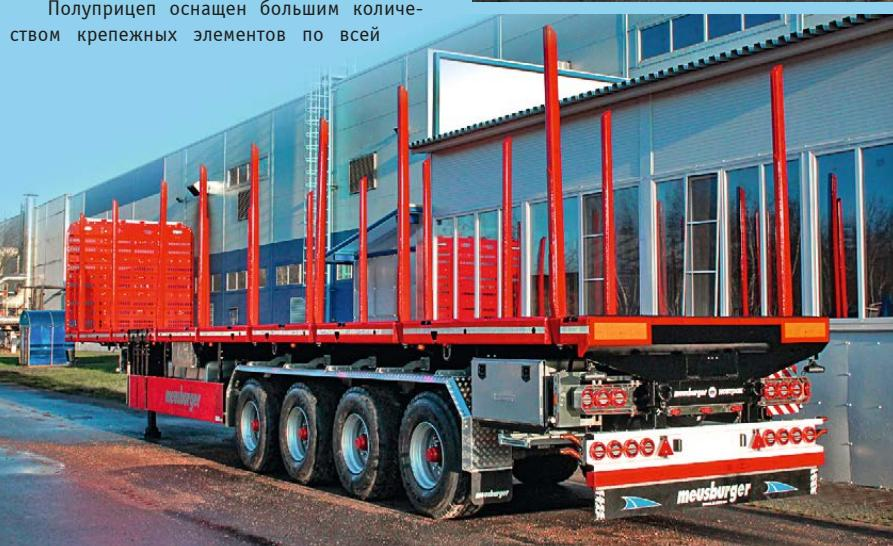
предназначенных для обеспечения надежной фиксации длинномерных грузов, например, строительных материалов или металлических конструкций. Внутренняя ширина коников по необходимости может быть увеличена до 3000 мм.
