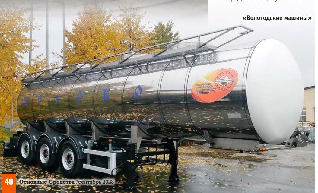
нержавеющая сталь AISI-304. Термоизоляция емкости – вспененный полиуретан, система мойки – моющие головки щелевого типа в каждой секции.
