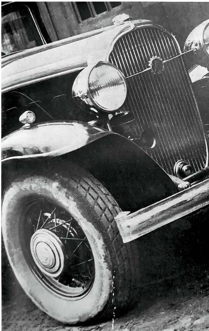
Рис. 13. Колесо с шиной «баллон» 775x145, автомобиль Л-1
