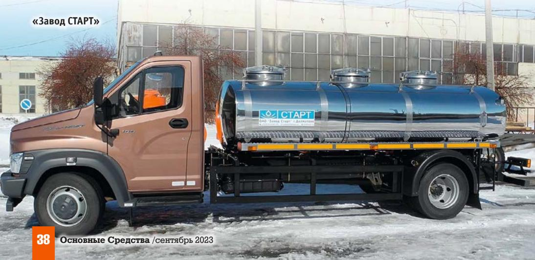
вого спирта с корпусом из коррозионностойкой стали. Соответствуют требованиям ДОПОГ и требованиям Федеральной службы «РОСАЛКОГОЛЬРЕГУЛИРОВАНИЕ». Модели представлены от небольших объемов на шасси газель и рабочей вместимостью 1,2 до 1,6 м<sup>3</sup> на базе шасси КАМАЗ. Автоцистерны могут быть укомплектованы системой «Глонасс».
