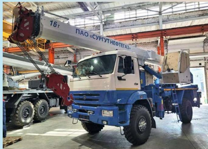
специальным ограждением датчик длины стрелы БСМ, дополнительно защищили стекла кабины от стропов и от ветровой нагрузки.
