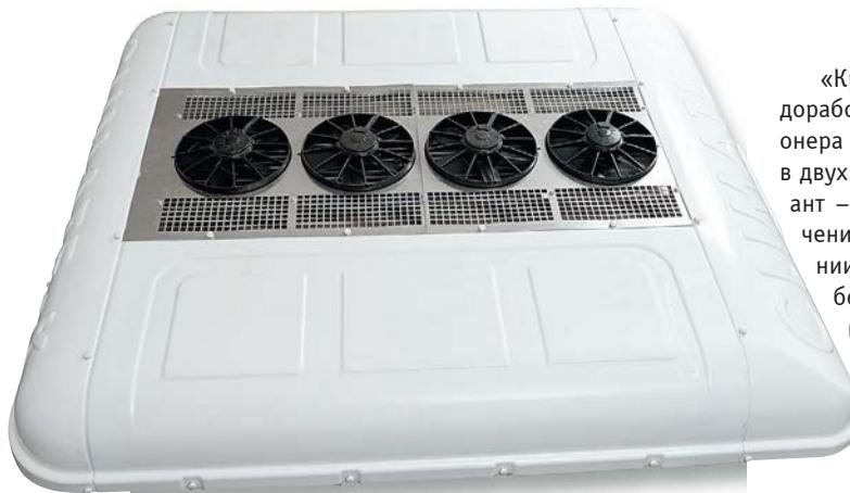
Моноблоки работают с электрическими и механическими компрессорами. Так, блоки CLE1 и CLE2 подключают к электрическому компрессору, а при оснащении трансформатором блок можно подключать к внешней сети напряжением 220 В, что позволит сохранить заряд аккумулятора машины. Блок CLM5 может работать как с электрическим компрессором, так и с механическим, который устанавливают на кронштейне в моторном отсеке. Моноблоки мощностью 7 кВт и выше работают только с механическим компрессором.
