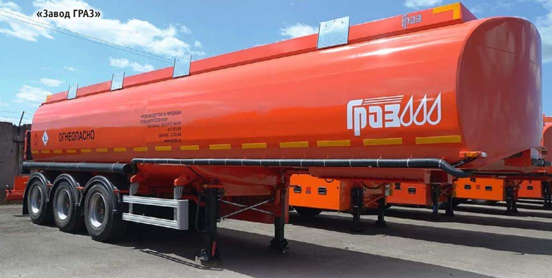
**АО «Завод ГРАЗ»** (г. Нижний Новгород) предлагает широкую номенклатуру автоцистерн, прицепов и полуприцепов-цистерн с постоянным сечением в форме круга, овала или «чемодана», а также круга или чемодана переменного сечения: с усечением в передней части либо «гусиная шея». Цистерны оснащаются внутренними ребрами жесткости (волнерезами) плосковыпуклой формы.
