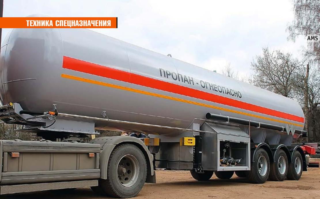
Цистерна постоянного сечения круглой формы, выполнена из стали 10Г2ФБ толщиной 10 мм. Не разделяется на отсеки. Шасси 3-осное (одна из осей подъемная), подвеска пневматическая, тормоза дисковые (или барабанные). Окраска производится после дробеструйной обработки двухкомпонентной краской (Германия, Бельгия).
