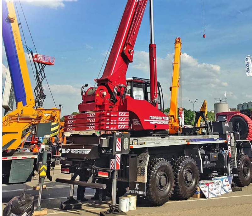
Автокран «Комсомолец» КС-55721-5В-1 грузоподъемностью 35 т
