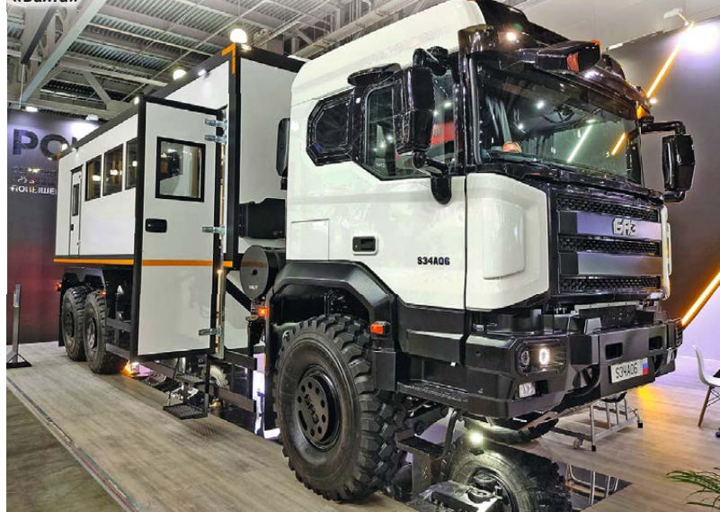
Вахтовый автобус БАЗ С34А06 «Вахта»
