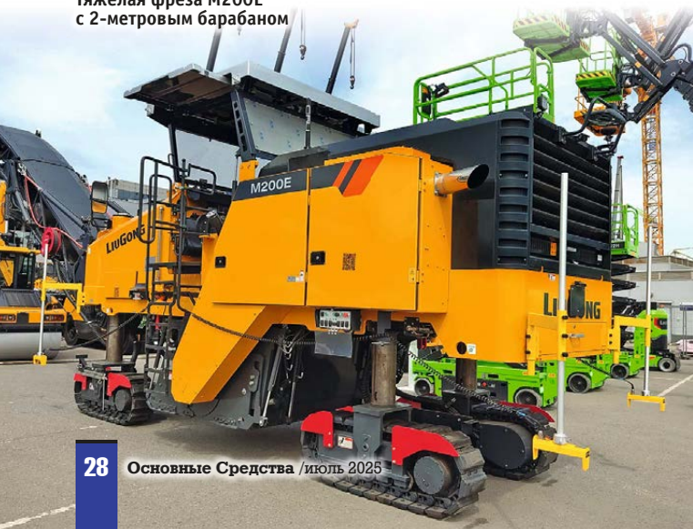
Тяжелая фреза M200E с 2-метровым барабаном
