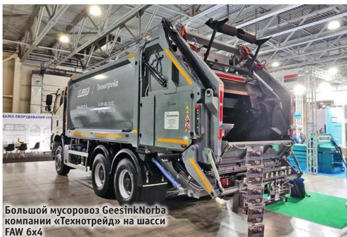
бункер выполнены из нелегированной конструкционной стали S355J2G3C. Выталкивающая плита сконструирована таким образом, что отодвигается вплотную к передней стенке кузова, что позволило увеличить полезный объем кузова. Телескопический цилиндр выталкивающей плиты используется для регулирования противодавления, что позволяет регулировать коэффициент прессования от 1 до 6 в зависимости от характера отходов.
