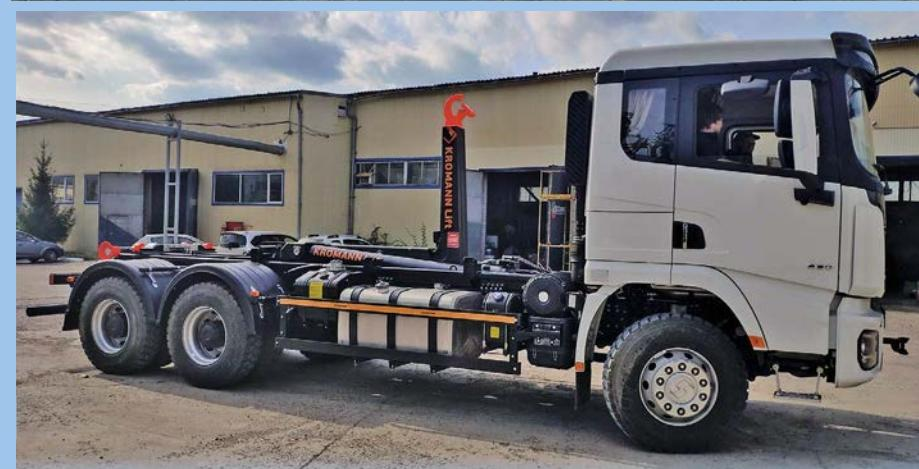
для работы в составе автопоезда. Крюковые погрузчики с большей рабочей длиной позволяют использовать сменные контейнеры длиной до 7 м объемом до 38 м<sup>3</sup>. Для повышения устойчивости
