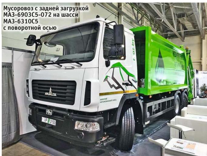
Мусоровоз с задней загрузкой МАЗ-6903С5-072 на шасси МАЗ-6310С5 с поворотной осью
