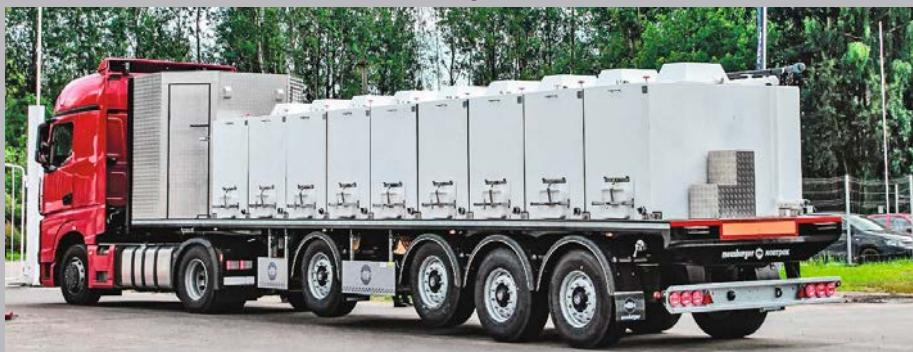
грузочными люками с шиберными задвижками. С целью увеличения временных рамок транспортировочного процесса в конструкции полуприцепа в каждом баке предусмотрена система пролива воды, изготовленная из полипропиленовых труб.
