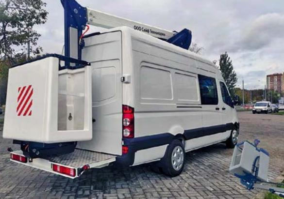
Компания «СОЛЛЕРС» объявила о пополнении гаммы модификаций Sollers Atlant вариантом с автогидроподъемником рабочей высотой до 15 м. Автомобиль построен на базе цельнометаллического фургона.
