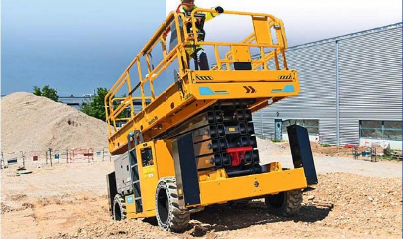
лесами из резины, которая не оставляет следов на полах. У некоторых подъемников платформы снабжены выдвижной секцией, которая позволяет увеличить длину платформы на 30%.
