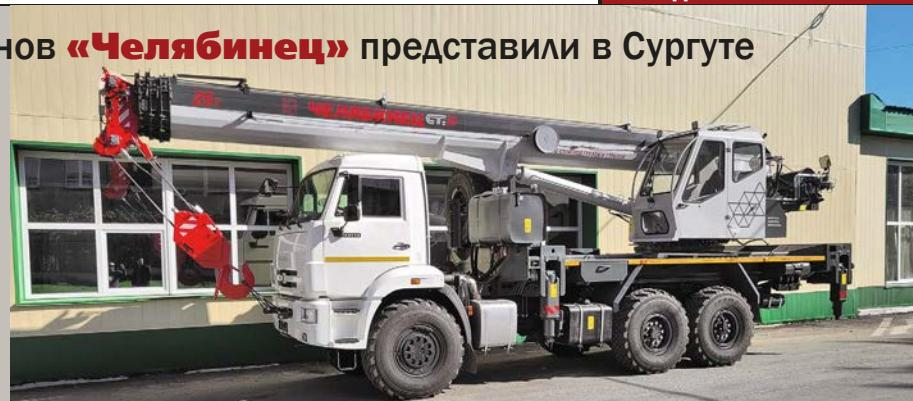
вылетах увеличена ширина опорного контура до 6,35 м. Управление выносными опорами реализовано с двух сторон машин (опционально можно установить световую и звуковую сигнализации при выдвижении опор). Новый гидросистема предоставляет возможность одновременного выдвижения-втягивания четырех опор, а также синхронную работу аутригеров, что значительно сокращает время приведения крана в рабочее положение.
