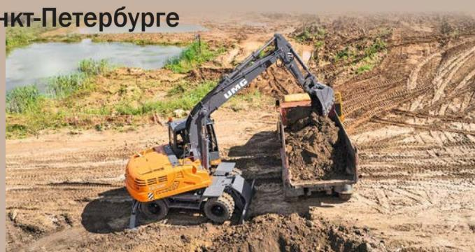
личительная особенность машин – многофункциональность. Так, покупатель может заказать или стандартное рабочее оборудование (стrela длиной 5,2 м и рукоять 2,2 м), или удлиненный вариант (доступны рукояти 2,53 м или 3 м). Помимо базового ковша емкостью 1 м<sup>3</sup> предлагаются специальные версии для различных сфер применения (траншейный, планировочный, погрузочный, зачистной, ковш-рыхлитель и т.д.).
