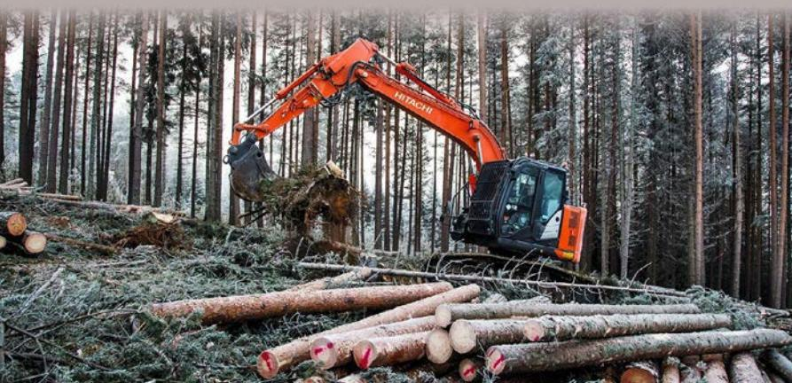
ZX135USL-7 потребляет до 9% меньше топлива, чем предыдущая модель. Это достигается с помощью гидравлической системы HIOS V от Hitachi. В составе гидросистемы два аксиально-поршневых насоса, производительность которых в сумме составляет 234 л/мин. HIOS V обеспечивает высокую точность движений рабочих органов машины. Экономию топлива можно повысить за счет контроля по новому «указателю экономичности» ECO на многофункциональном 8-дюймовом мониторе в кабине.
