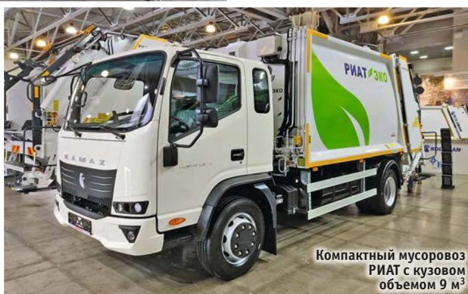
Компактный мусоровоз РИАТ с кузовом объемом 9 м<sup>3</sup>
