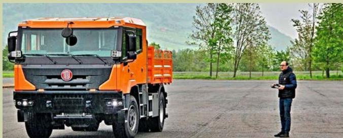
зированными системами управления транспортными средствами является возможность эксплуатации на труднодоступной местности или с пользователями с высокими требованиями. Например, спасательным и пожарным службам все чаще требуются машины с автоматическим вождением или дистанционным управлением, которые можно было бы отправлять в опасные зоны без экипажа. Автомобили Tatra с автоматизированным управлением могут найти применение в закрытых промышленных и горнодобывающих зонах.
