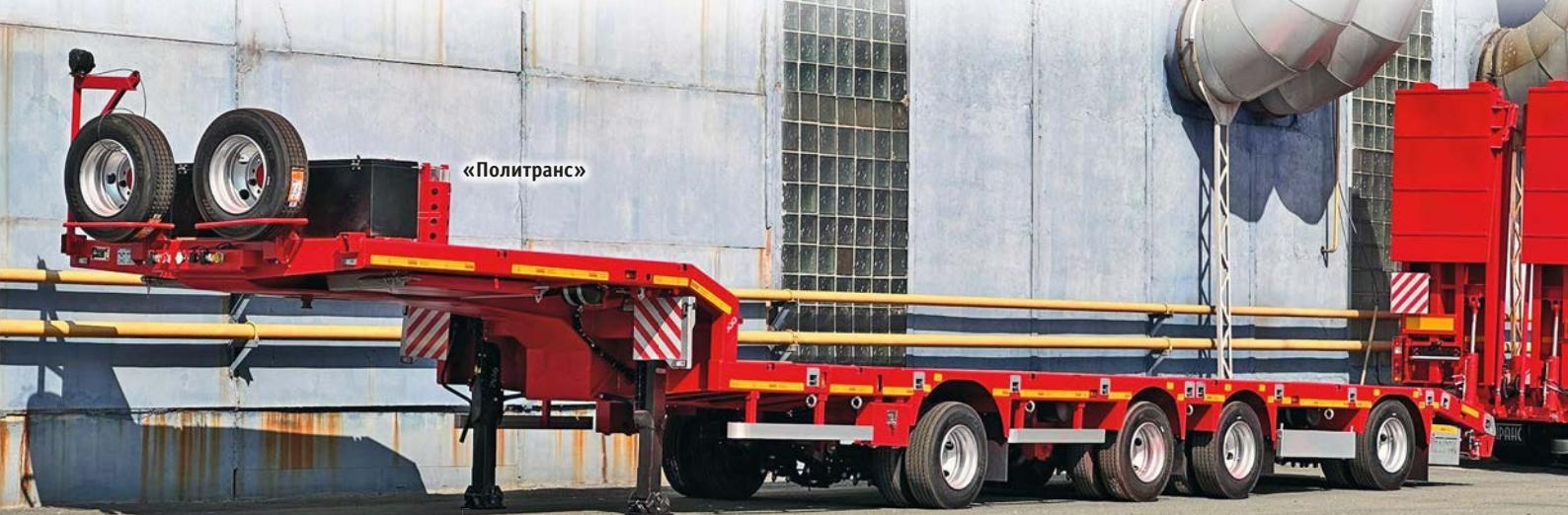
оснащена поворотными осями, а первая ось еще и подъемная! Таким образом, этот полуприцеп получает превосходную маневренность и может безопасно эксплуатироваться в условиях плотной городской застройки.
