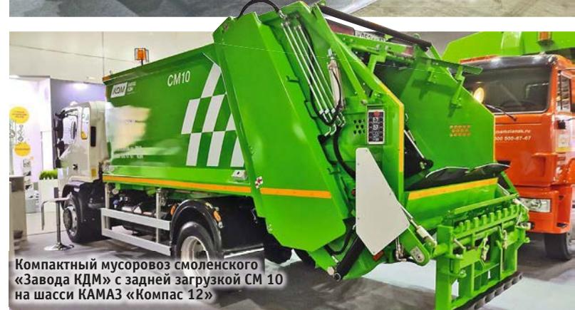
Компактный мусоровоз смоленского «Завода КДМ» с задней загрузкой СМ 10 на шасси КАМАЗ «Компас 12»
