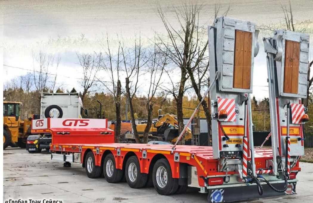
ников. Мы в целом снизили собственный вес траля, упростили работу с трапами, разработали собственную электрическую схему без спаек – всё комплектное, провели работу над подготовкой к нанесению ЛКП и непосредственно над покраской рамы полуприцепа, трущие-
