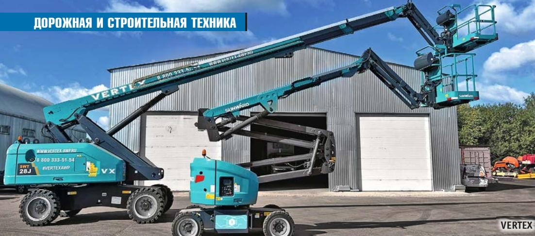
электрические ножничные подъемники с рабочей высотой 8, 10, 12, 14 и 16 м, электрические коленчатые с рабочей высотой от 16 до 22 м, дизельные коленчатые машины 16–48 м и телескопические дизельные машины с высотой подъема 22–32 м. Машины предназначаются как для конечных потребителей, так и для арендного сектора.
