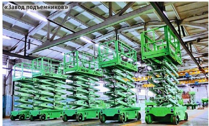
Но зато они имеют самую высокую грузоподъемность среди подъемников всех рассматриваемых типов. Их подъемный механизм проще по конструкции по сравнению с телескопическими и коленчатыми подъемниками. Специалисты отрасли относят к достоинствам ножничных подъемников хорошую устойчивость и плавный, но в то же
