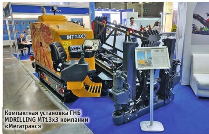
Компактная установка ГНБ MDRILLING MT13x3 компании «Мегатранс»
