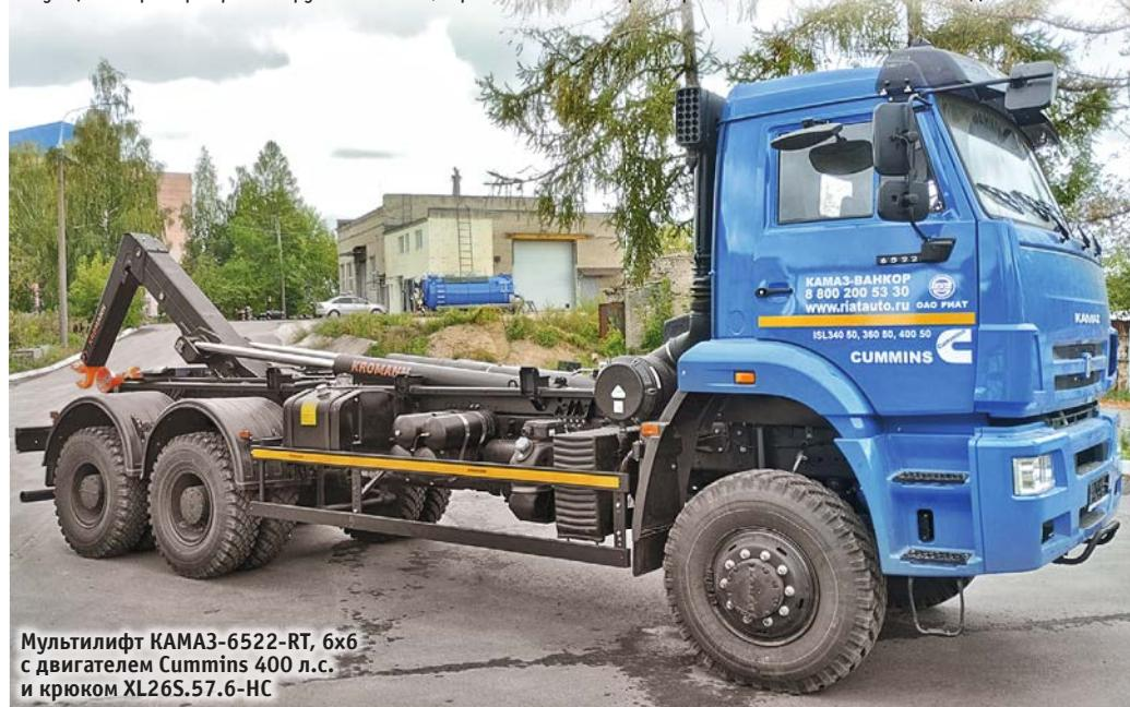
**Мультилифт КАМАЗ-6522-РТ, 6x6 с двигателем Cummins 400 л.с. и крюком XL26S.57.6-НС**
