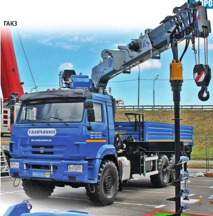
Кроме того, следует учитывать условия будущей эксплуатации КМУ. Если предполагается работать в городе на относительно проходимой местности (даже заезжая на городские стройплощадки), видимо, достаточно будет неполноприводного шасси. А вот если эксплуатация предполагается за городом, на пересеченной местности, нужно выбрать шасси с полным приводом.
