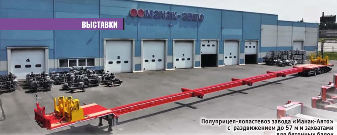
Полуприцеп-лопастевоз завода «Манак-Авто» с раздвижением до 57 м и захватами для бетонных балок
