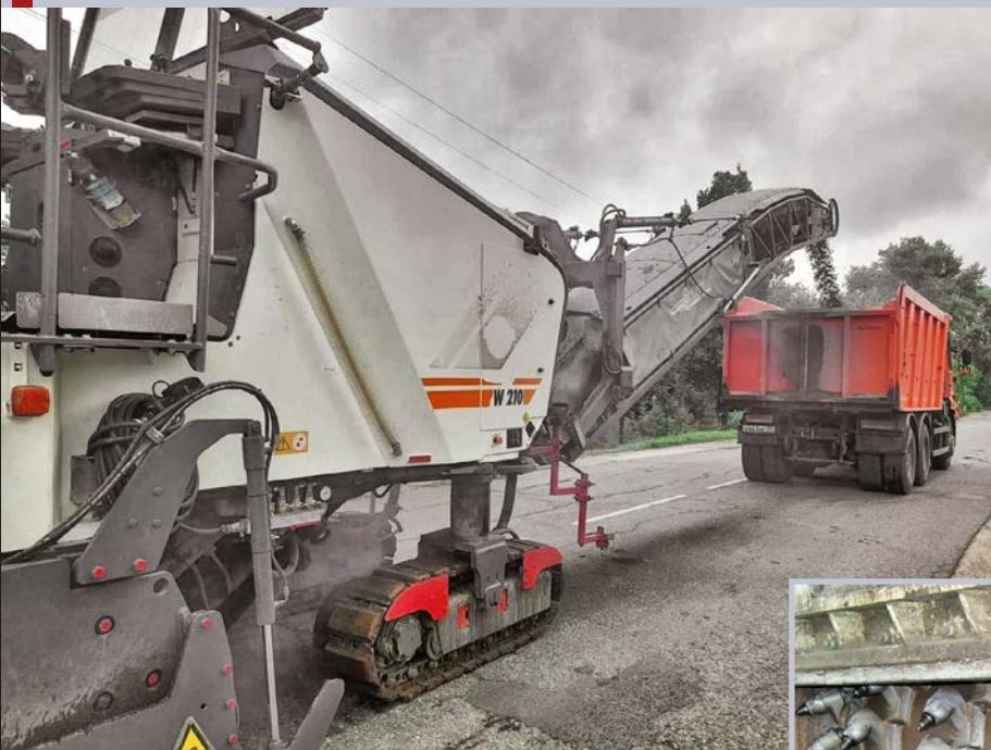
Опытные испытания резцов дорожной фрезы, изготовленных в Ивановской области, проходят на участке кадримонта км 343 – км 354 федеральной автомобильной дороги А-108 «Московское большое кольцо» в районе Серпухова.
