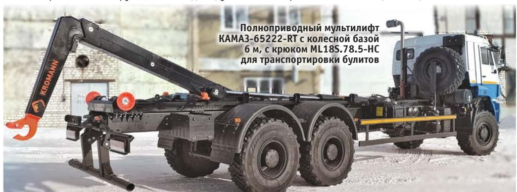
Полноприводный мультилифт КАМАЗ-65222-RT с колесной базой 6 м, с крюком ML18S.78.5-НС для транспортировки булыток
