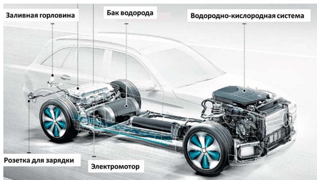
Рис. 4. Легковая автомашин с водородно-кислородным приводом
